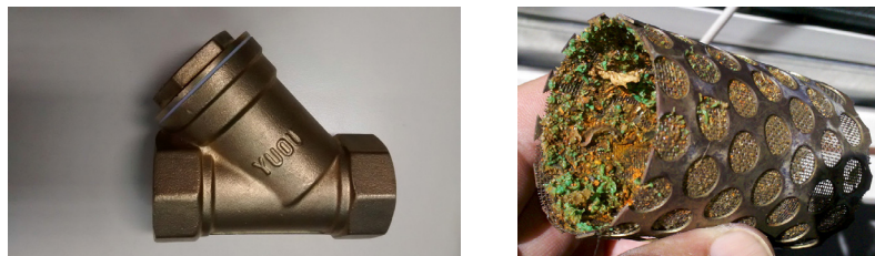
Figura 9. Filtro tipo "Y" e filtro obstruído com sujeira
