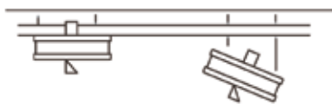
Alinear con regla a lo largo de las caras de la polea
