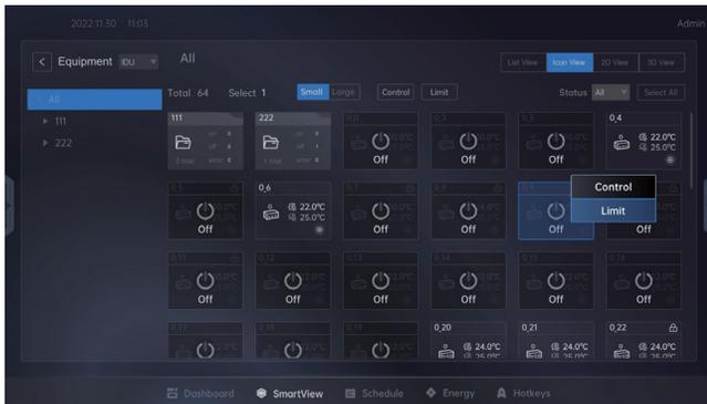
Luego de seleccionar las IDU, haga clic con el botón derecho del mouse para ver el menú y haga clic en "Limit". Luego, se expandirá el panel Limit.
