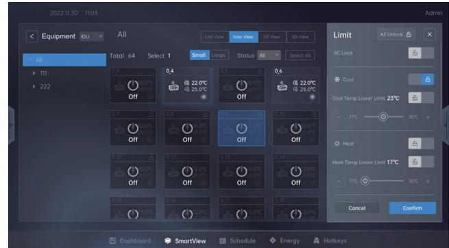
El botón "All Unlock" en la esquina superior derecha del panel puede cambiar la configuración de límite All para desbloquear. La siguiente tabla describe cada configuración de límite.
