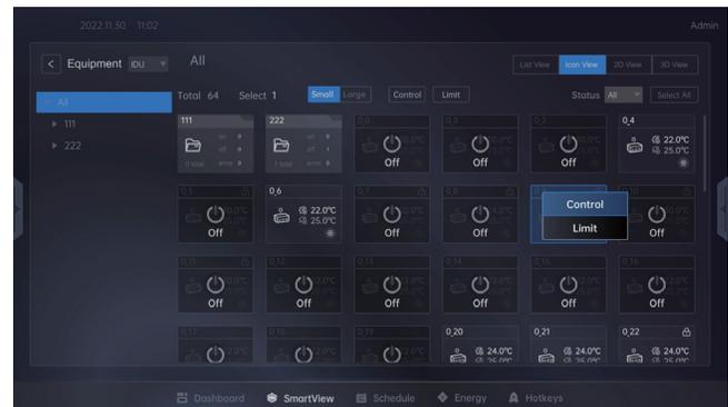
Haga clic en "Control" y se mostrará el panel de control. Luego el usuario podrá realizar el control remoto del dispositivo seleccionado.
