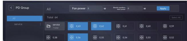
Los usuarios pueden ingresar la potencia de entrada del ventilador y del calentador auxiliar eléctrico según la situación real, y luego hacer clic en "Apply" para aplicar la configuración de potencia para la IDU seleccionada. Si no están configurados, los parámetros predeterminados de la IDU se usan para el cálculo.
