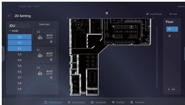
Haga clic para seleccionar un piso de la columna derecha, y arrastre una IDU de la lista de IDU hacia la vista de plano. La IDU puede colocarse en un sitio específico en la vista de piso 2D si libera el mouse.
