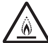
Precaución: Riesgo de incendio (para IEC 60335-2-40: 2018 únicamente)
